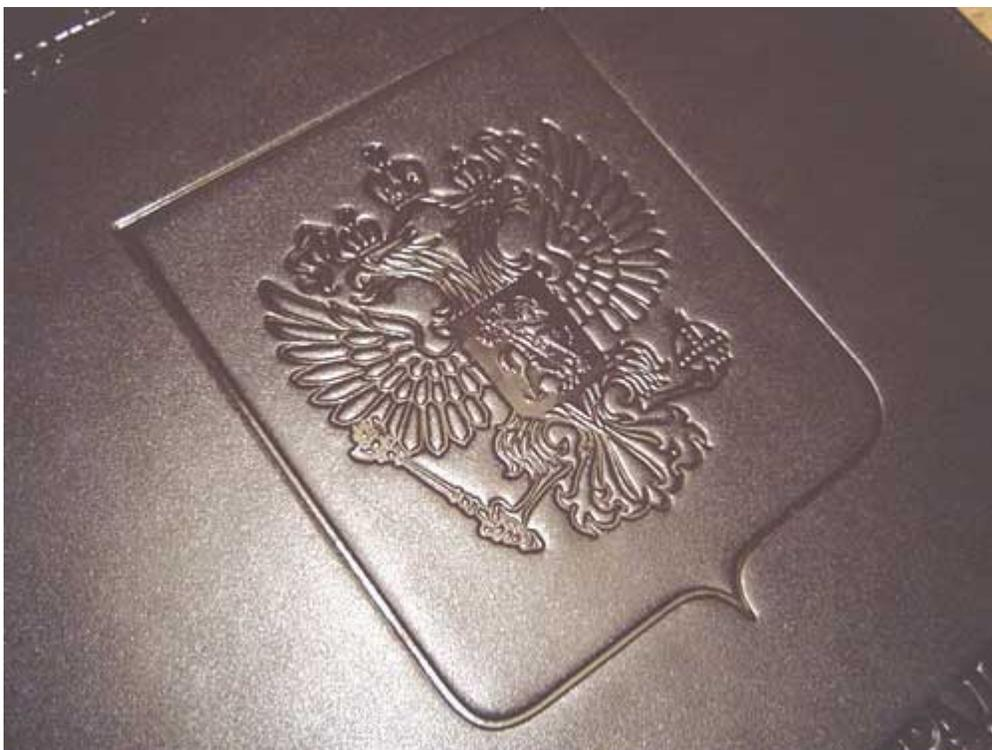
**Рис. 3. Пример блинтового тиснения**
