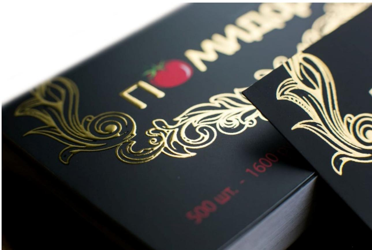
**Рис. 1. Тиснение металлизированной фольгой.**
